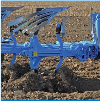
HydroAvant, die hydraulische Non-Stop Steinsicherung
