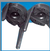
4 Kreismesser pro Meter, schleppend angestellt
